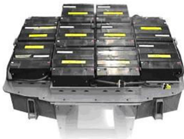
obr. 9.1.6 Lithium-iontové články vyvinuté pro Mitsubishi firmou Matsushita Electric (Panasonic).
